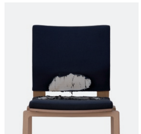
Papierkissentest Polsterverbund ULTRA: Brand selbstständig verloschen (nach ca. 5 Minuten)
