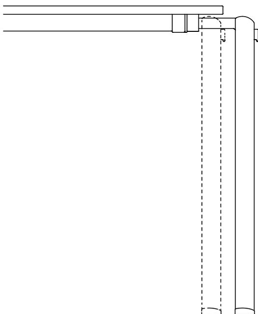
Eine patentierte Funktion ist das nach außen schieben der Beinpaare. Damit sind die Beine ausgeschoben stapelgerecht, zurückgeschoben gewährleisten sie, dass die Tischplatten bündig, also ohne Distanz, aneinander gereiht werden können, wie es im Bankettbereich für die Nutzung gefordert ist.
