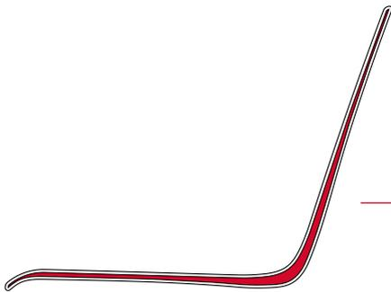
Eine besondere Raffinesse liegt im technischen Aufbau der Schale. Sie ist im sogenannten 2-K-Verfahren erzeugt: Innen hat sie einen harten stabilen Kern aus PP-GF (Polypropylen mit Glasfaseranteil) und außen ist sie vollständig in einem haptisch angenehm weichen PP (Polypropylen).
