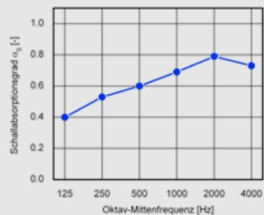
1 Deckenabsorber mit Pendelleuchte
